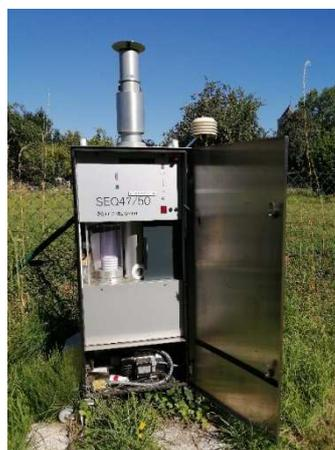
Figure 8 : Appareil de mesure des HAP particuliers -
