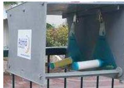
Figure 7 : Tubes à diffusion passive -
