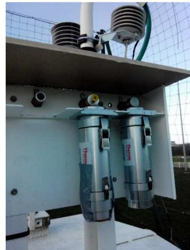
Figure 9 : Appareil de mesure des acides minéraux -
