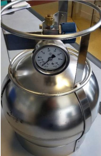
Les canisters sont des enceintes en acier inoxydable (volume = 6L dans le cas des modèles utilisés par Atmo Normandie) permettant d'effectuer des prélèvements d'air. Ils sont le plus souvent utilisés en dépression, c'est-à-dire qu'ils sont préparés sous vide et qu'une simple ouverture de vanne permet de prélever l'échantillon. Des régulateurs de débit ('Veriflow') peuvent être utilisés en amont de la vanne pour réaliser des prélèvements intégrés sur plusieurs heures.
