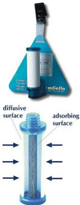
Les tubes à diffusion passive sont constitués d'une membrane microporeuse et d'un adsorbant sur lequel les composés d'intérêt vont venir s'accumuler par diffusion moléculaire sur des périodes allant typiquement de 7 à 14 jours. Les composés sont ensuite extraits de la cartouche au laboratoire par désorption chimique ou thermique avant d'être analysés.
