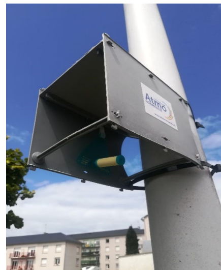
Figure 5: Exemple de tube passif à diffusion installé par Atmo Normandie dans le cadre de la gestion l'incendie de SPHERE.
