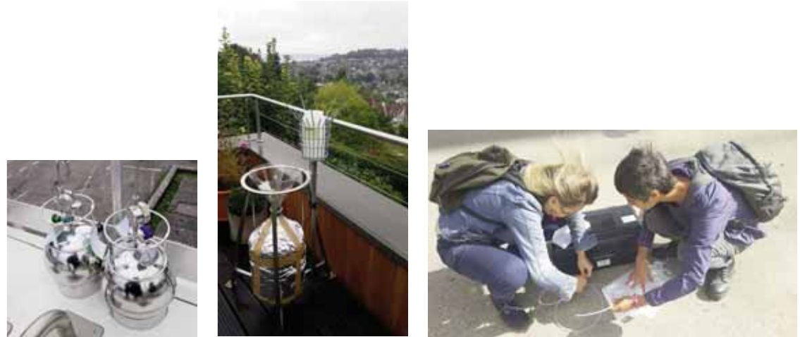
Atmo Normandie a mis en œuvre de nombreux instruments de mesures. Ici, quelques dispositifs de prélèvement d'air ou de retombées (de gauche à droite) : canisters, jauges, sacs Tedlar.
