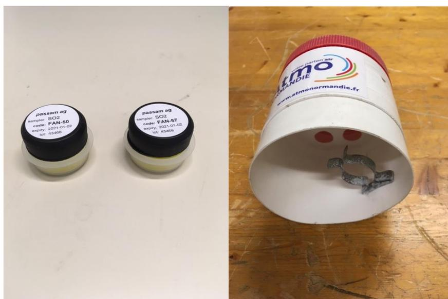
Figure 6 : Photographies des échantillonneurs passifs SO<sub>2</sub> et du boîtier d'installation des tubes, Atmo Normandie, 2021.
