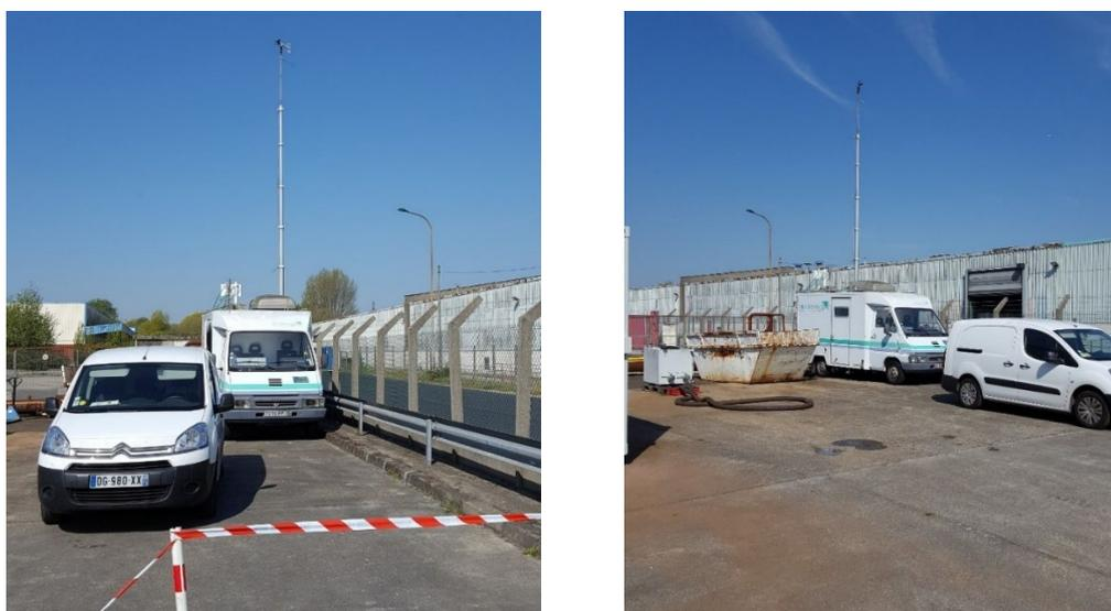
Figure 11 : Deux vues du camion laboratoire équipé d'un appareil de prélèvement et d'un mât météorologique installé en ZI du Havre "Est"
