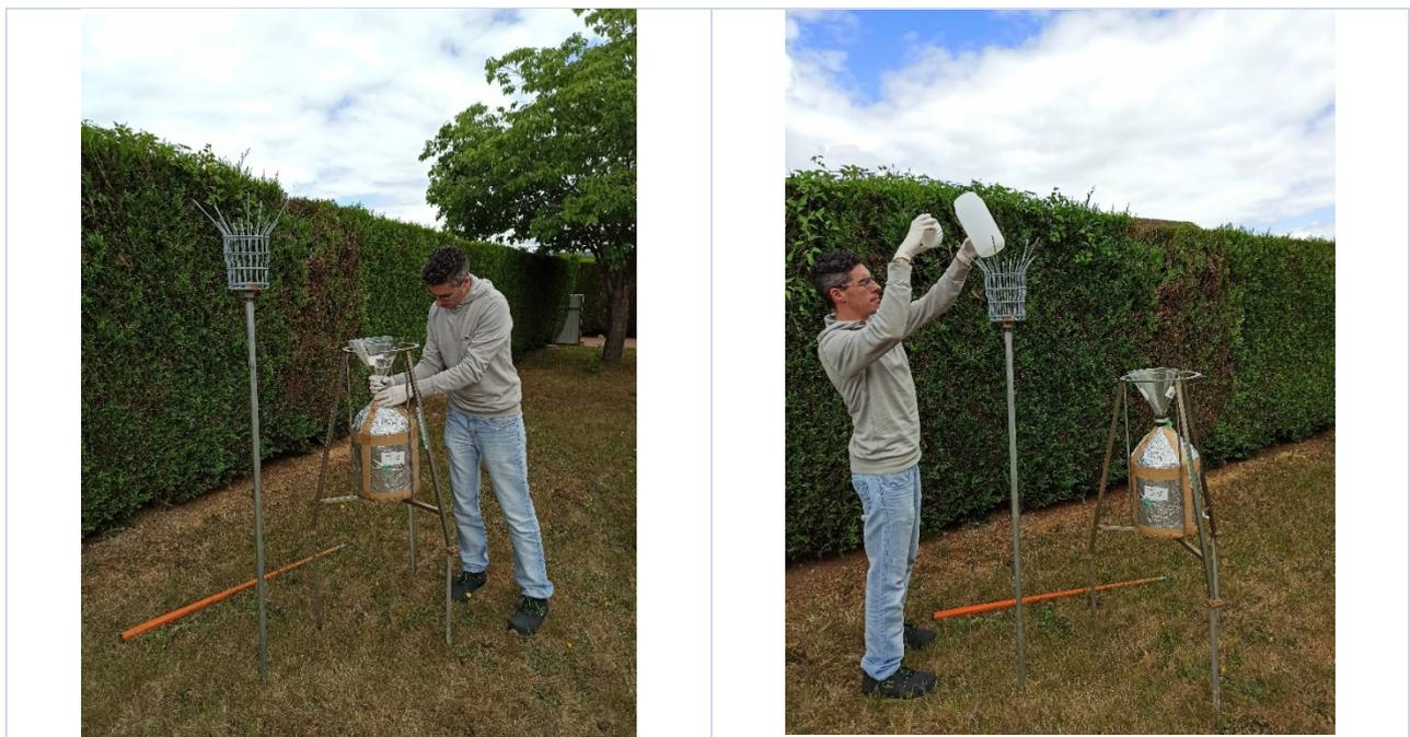
Figure 2 : Photographie de l'installation des jauges Owen (dioxines) et Bergerhoff (métaux) sur le site numéro 5
