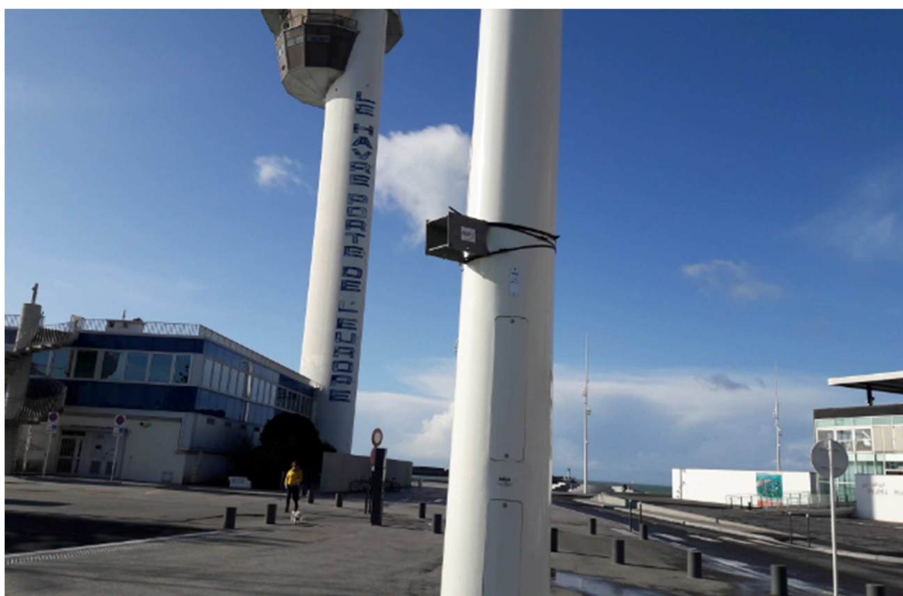
Figure 3 : Installation du matériel pour la mesure du dioxyde d'azote et des BTEX sur le terrain.
