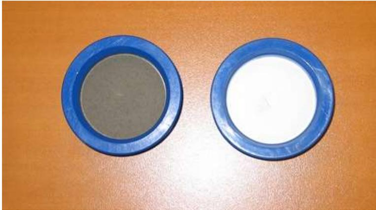
Figure 4 : Exemple de photos de filtres (à gauche un filtre après prélèvement des poussières PM10, à droite un filtre vierge)
