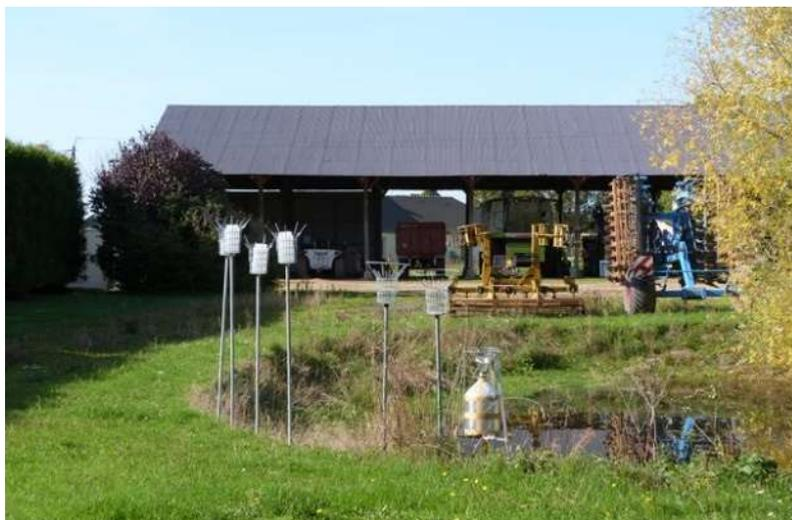
Figure 2 : Photographie des jauges de dépôt
