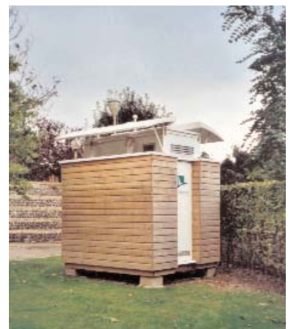
Nouvelle génération de station de mesures d'Air Normand. (ici à Gonfreville l'Orcher)
