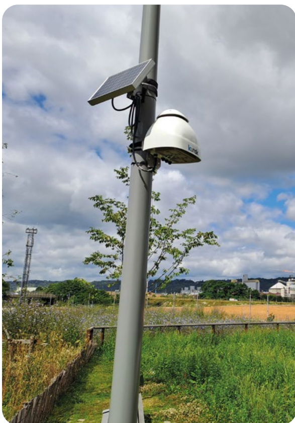
Mini-station mesurant le dioxyde d'azote (NO 2 ) et les particules PM10 et PM2,5 dans l'air.
